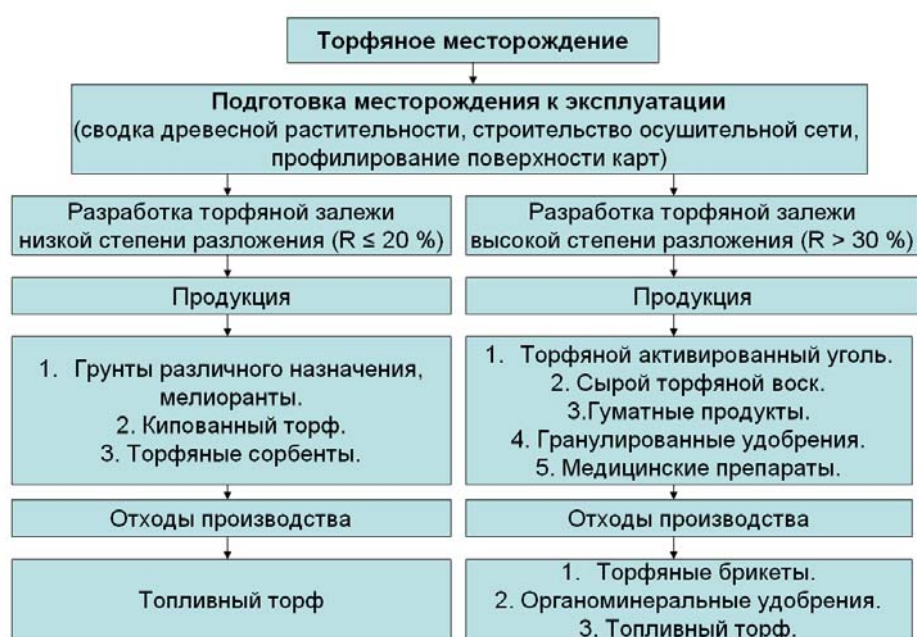
Рисунок. Схема глубокой безотходной ресурсосберегающей комплексной переработке торфа
