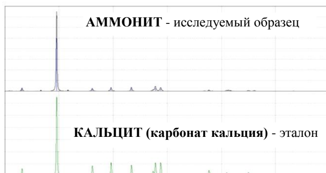
Рисунок 1 – Результаты рентгенофазового анализа ростра белемнита (анализ проведён во ФГУП «РФЯЦ – ВНИИЭФ»)
