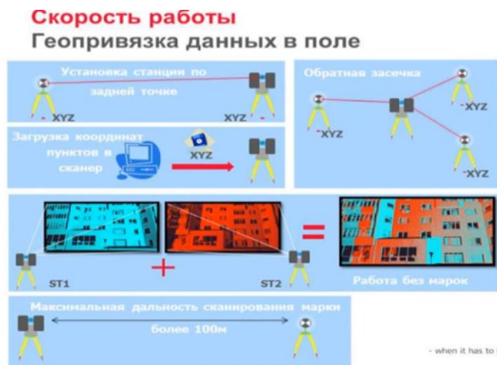
Рис. 3. Технологическая схема привязки в поле
