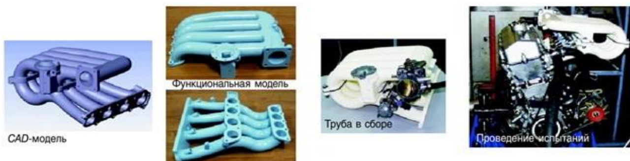
Рисунок 9. Испытание впускного трубопровода двигателя
