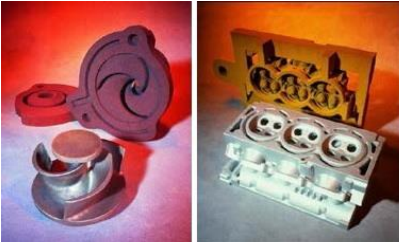
Рисунок 45. Песчаные формы и отливки (EOS)
