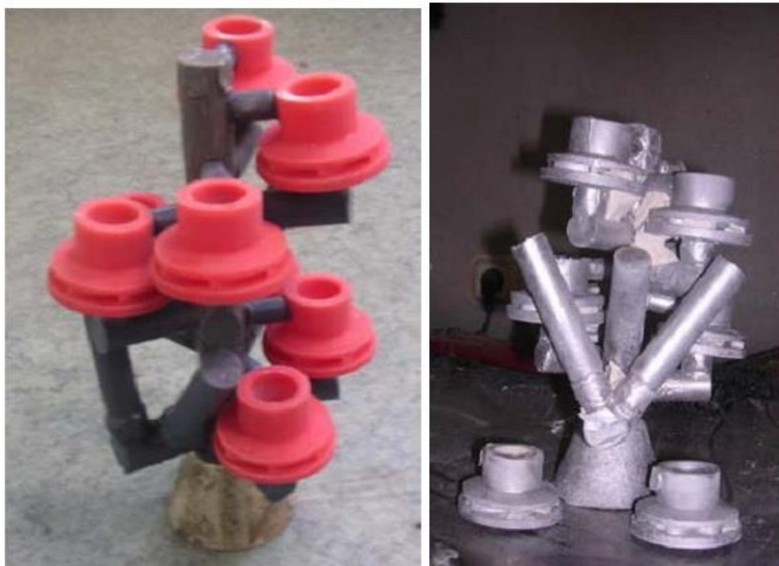
Рисунок 21. Полистирольные модели и отливки из алюминия
