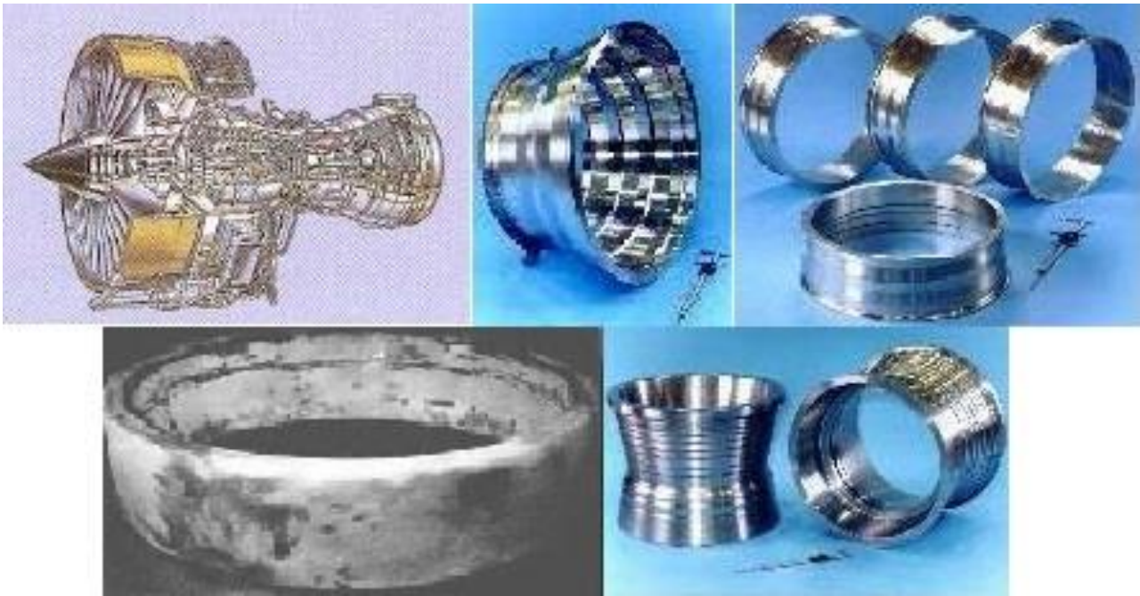
Рисунок 55. Примеры деталей авиадвигателя, полученные с использованием технологии «Spray forming»
