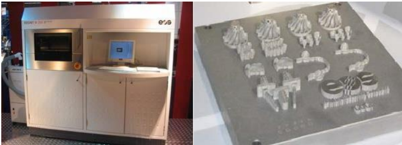
Рисунок 48. Машина EOS EOSINT M-270 и образцы выращенных металлических изделий
