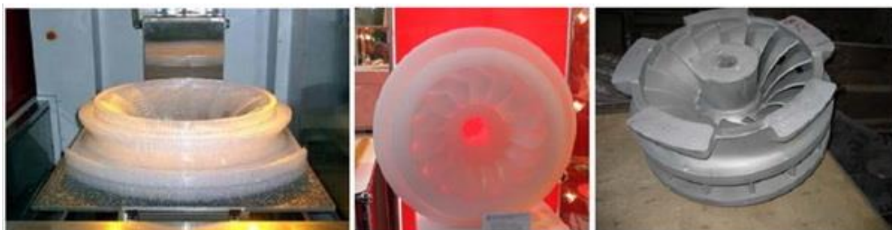
Рисунок 26. SLA-модель и отливка рабочего колеса турбоагрегата (ОАО «ТМЗ»)
