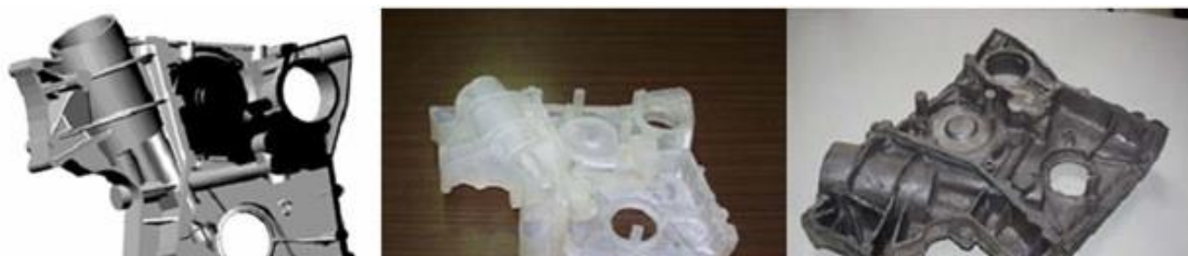
Рисунок 25. CAD-модель, SLA-модель и отливка передней крышки ДВС «в землю»
