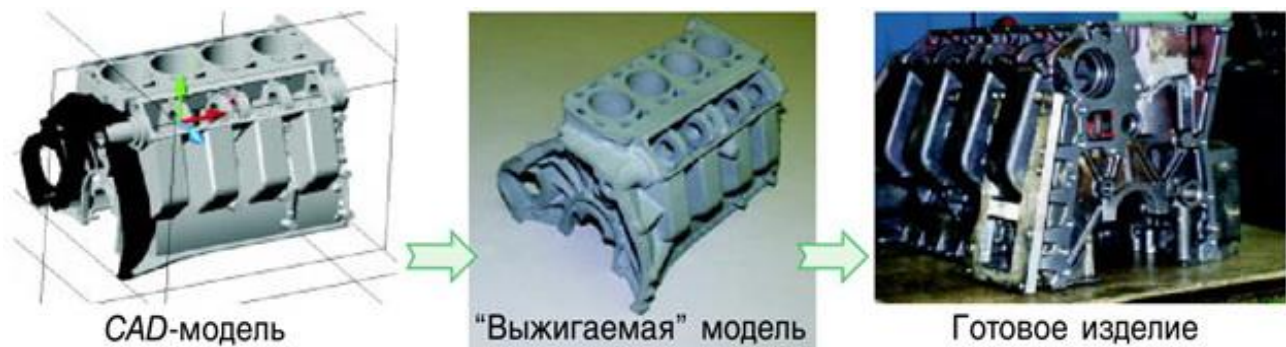
Рисунок 3. Быстрое прототипирование на примере блока цилиндров
