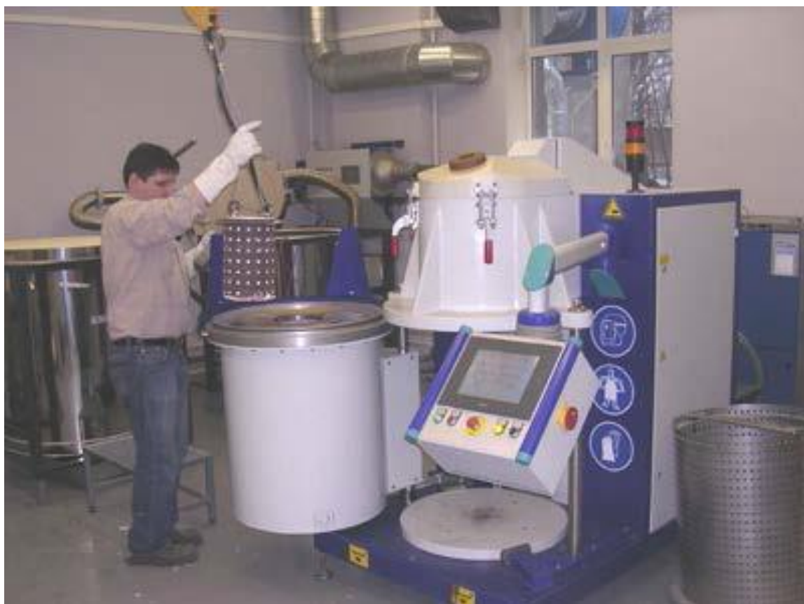
Рисунок 36. Вакуумная машина MPA 1000 (MTT Technologies) с объемом тигля 10 л для литья цветных металлов
