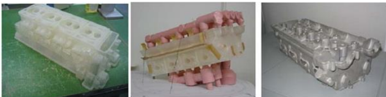
Рисунок 24. Quick-cast модель, она же с литниковой системой и отливка головки цилиндров (алюминий)
