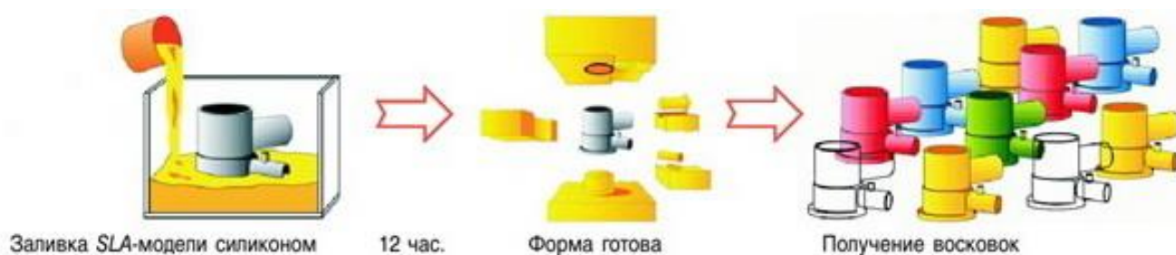
Рисунок 15. Изготовление восковок в силиконовых формах
