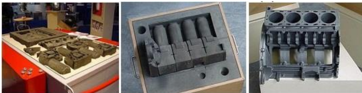
Рисунок 42. Выращенные фрагменты формы (ProMetal), форма в сборе и отливка блока (чугун)
