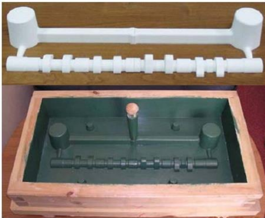
Рисунок 22. SLS-модель распределительного вала и формовочный ящик
