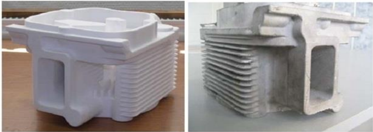
Рисунок 19. Полистирольная модель и отливка цилиндра ДВС
