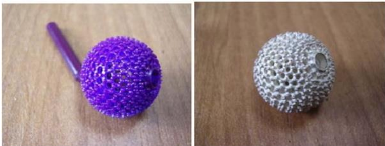
Рисунок 23. SLA-модель и отливка изделия из серебра «шарик»
