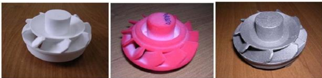
Рисунок 20. Полистирольная модель (после выращивания и инфильтрации) и отливка из чугуна
