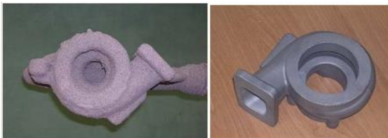
Рисунок 32. Оболочковая форма и отливка корпуса турбины (чугун), полученные по восковой модели
