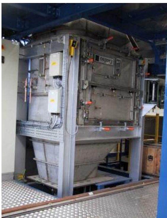
Рисунок 56. Установка Spray forming Оксфордского университета, (до 80 кг по Al)
