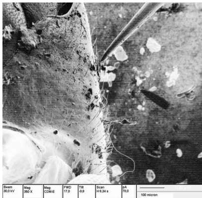
Рисунок 1. Микрозахват работает с сенсилью – волоском на ножке комара
