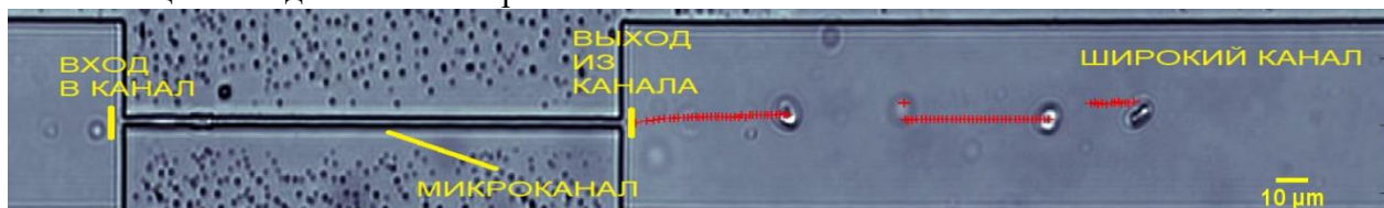
Рис. 1. Микроканал для исследования транспорта эритроцитов и результат работы алгоритма.
