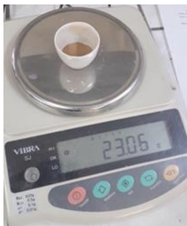
Рис.7. Фарфоровый тигель на технических весах
