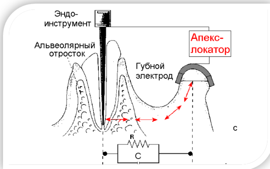
Рис.2 Схема электрической цепи апекслокатора
