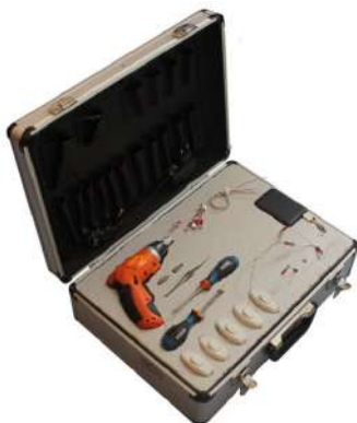
Рис. 3. Мобильный симулятор производственных процессов («Завод по сборке электрических выключателей») [5]
