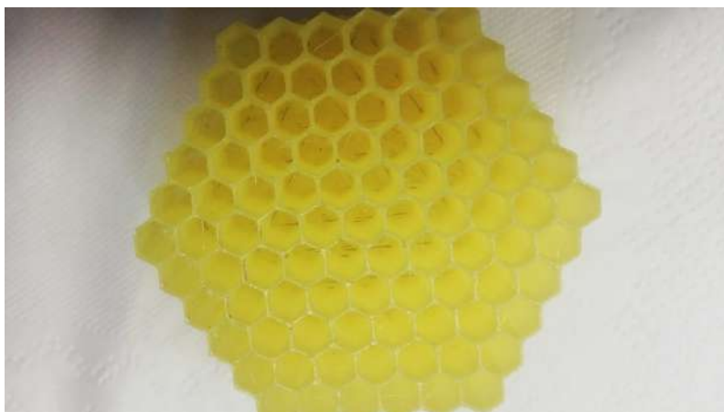
Рис. 3. Модель искусственных сотов, напечатанных на 3d-принтере с использованием филамента eSUN PLA желтый
