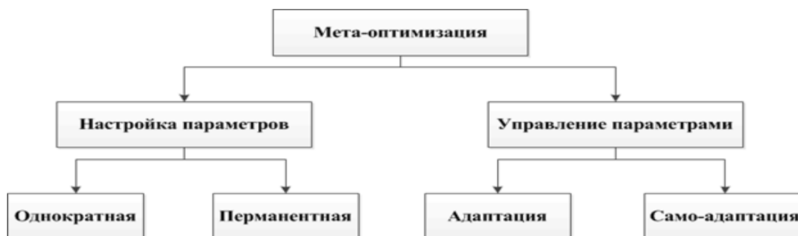
Рис. 1. Классификация методов метаоптимизации Эйбена
