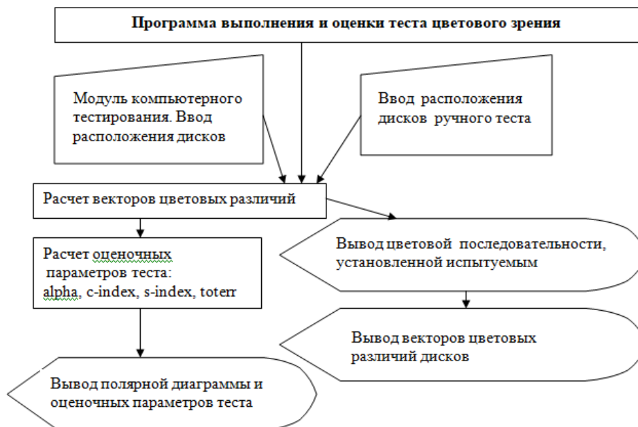
Рис.1. Структурная схема программы тестирования цветового зрения
