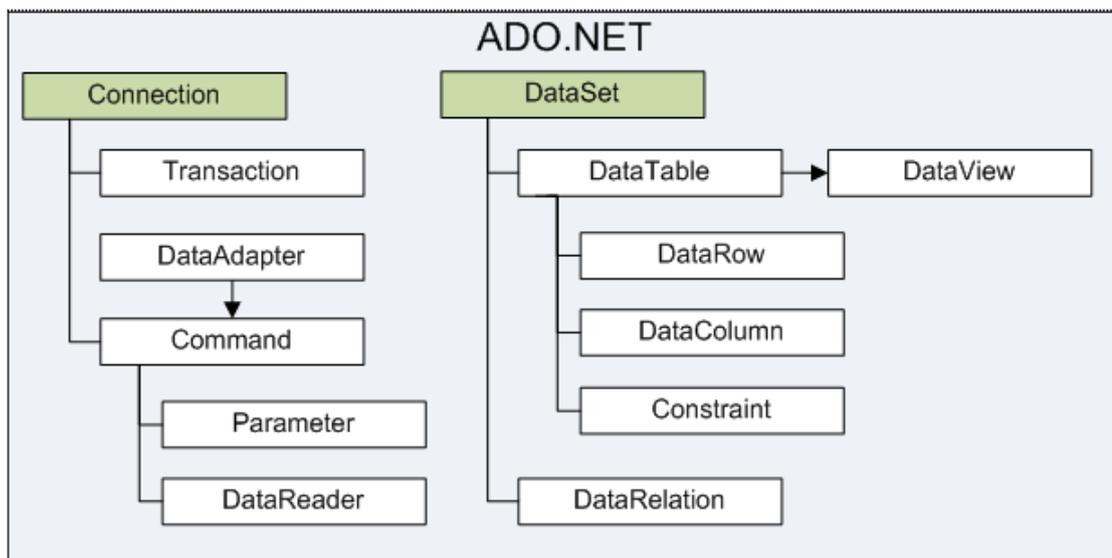
На рисунке показаны классы, составляющие объектную модель ADO.NET. Объекты в левой части называются подсоединенными (connected). Для управления соединением, транзакциями, выборки данных и передачи изменений они взаимодействуют непосредственно с БД. Объекты в правой части называются отсоединенными (disconnected), они позволяют работать с данными автономно.
