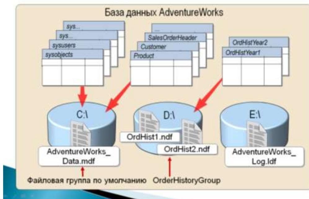
Данные внутри файловой группы распределяются по файлам пропорционально свободному месту в файлах. Например, если в файле f1 свободно 100 МБ, а в файле f2 - 300 МБ, то в файл f1 будет записана одна часть данных, а в файл f2 - три части, при этом оба файла будут заполнены примерно в одно и то же время.
