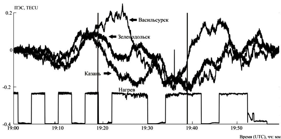
Рис. 5. – Вариации ПЭС, зарегистрированные в Василиурске, Казани и Зеленодольске 24.08.2014 г. для спутника GPS №32. Режим излучения мощной волны во время пролета спутником ДН стенда – 8 мин. нагрев, 4 мин. – пауза. Вертикальными сплошными линиями отмечен интервал пролета спутника GPS №32 над ДН стенда «Сура».
