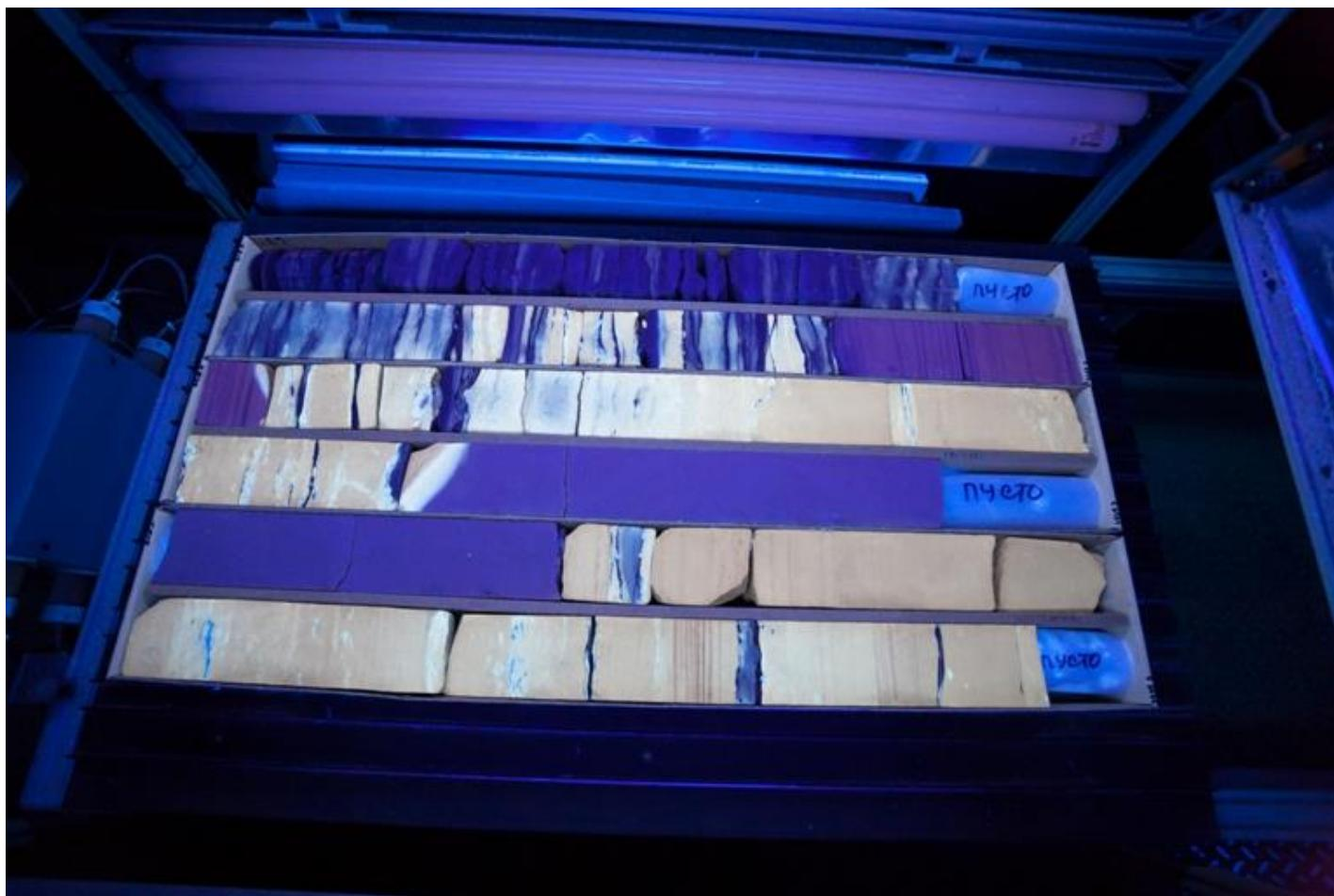
Рис. 3. Фотография керна в ультрафиолетовом свете после продольной распиловки
