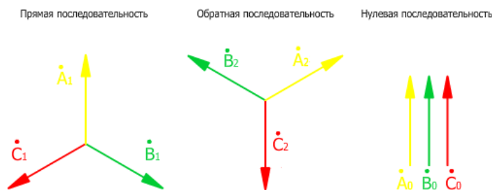
Рис. 2.1. Векторные диаграммы прямой, обратной и нулевой последовательности
