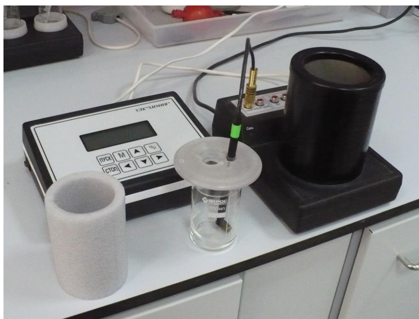
Рис. 4. Калориметр учебно-лабораторного комплекса (УЛК) «Химия», разработанного в Томском политехническом университете
