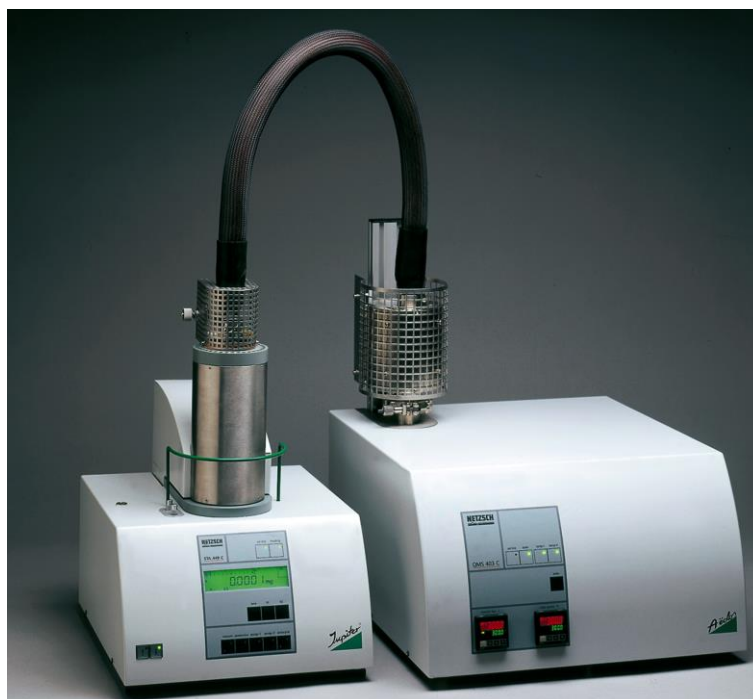
Рис. 22. Фотография совмещенного ТГ/ДСК термоанализатора STA 449C Jupiter (слева), сопряженного с квадрупольным масс-спектрометром QMS 403C Aeolos (справа)
