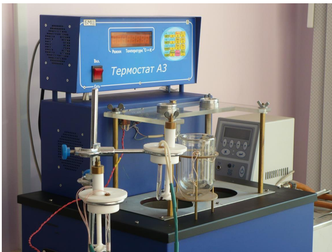
Рис. 6. Калориметр растворения, изготовленный сотрудниками кафедры физической химии КФУ
