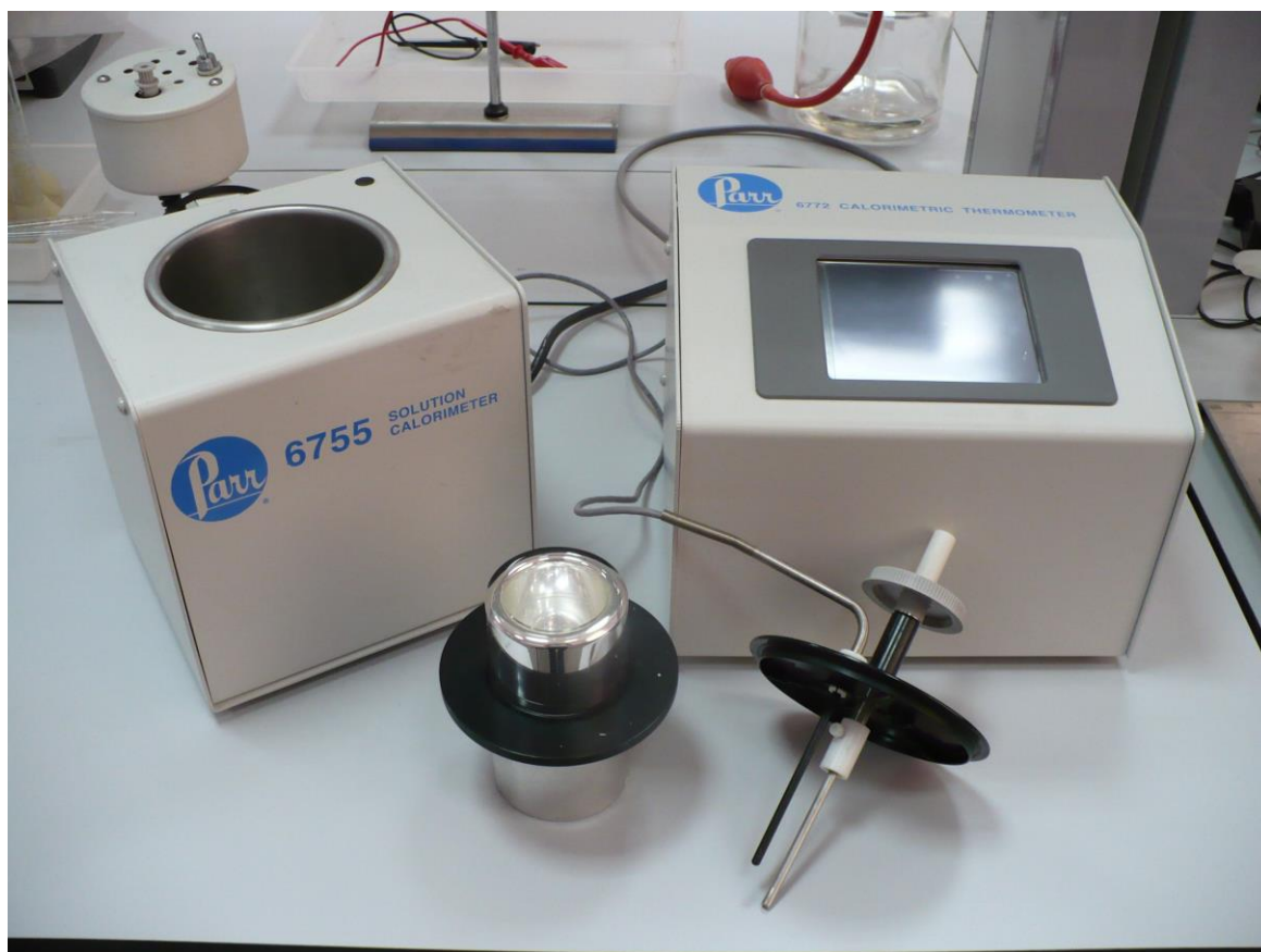
Рис. 5. Калориметр растворения, производимый фирмой «Parr Instrument Company» (США)
