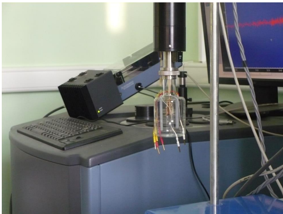
Рис. 7. Прецизионный калориметр растворения-титрования, производимый фирмой «TA-Instruments». На переднем плане – калориметрическая ячейка; на заднем плане – термостат ТАМ III
