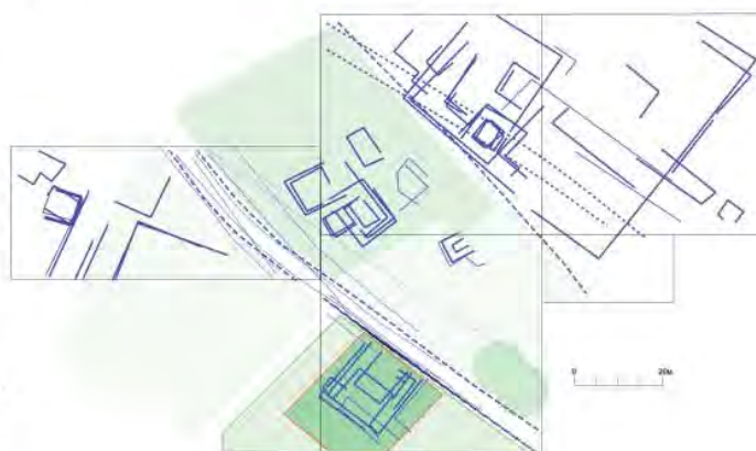
Рис. 3-В Результат геофизического исследования. Прорисовка изменений в грунте. Наложение на отдельные зоны, выявленные магнитометрией.
