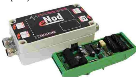
Рис.4 – Цифровой преобразователь для систем измерения веса eNod3-T фирмы SCAIME
