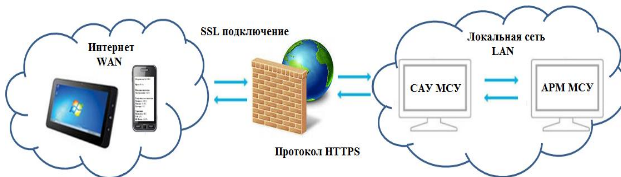
Рис. 1 - Структурная схема информационной сети программно-аппаратного комплекса
