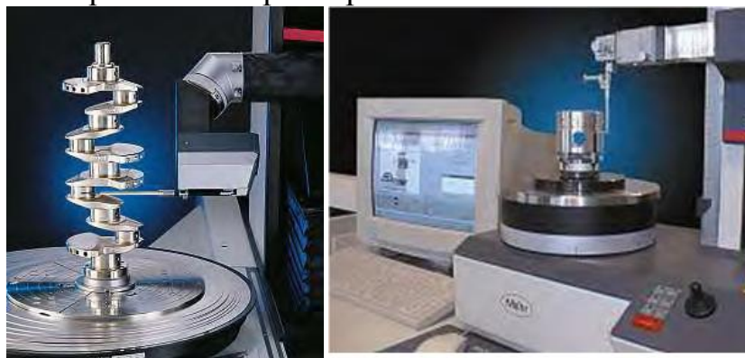
Рис. 1 – Установка измерений и контроля поверхностей вращения на базе специальных программ измерения геометрических параметров
