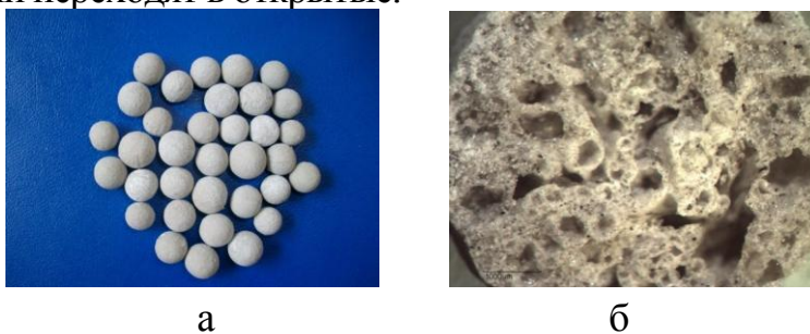
Рисунок 2 - Вспученный зернистый материал (а) и микроструктура среза гранулы (б)
