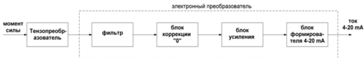
Рис. 6 – Функциональная схема электронного преобразователя
