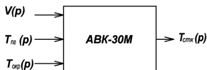
Рис. 1 – Структура модели АВК-30М по методу "черного ящика"
