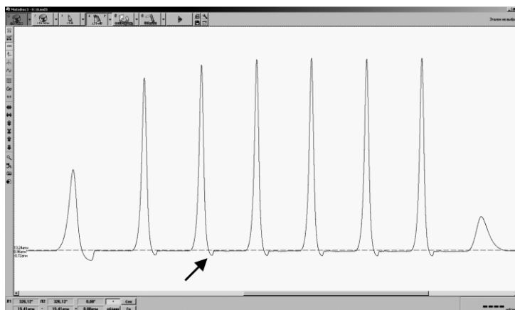
Рис. 1. Давление в цилиндре двигателя при проверке компрессии
