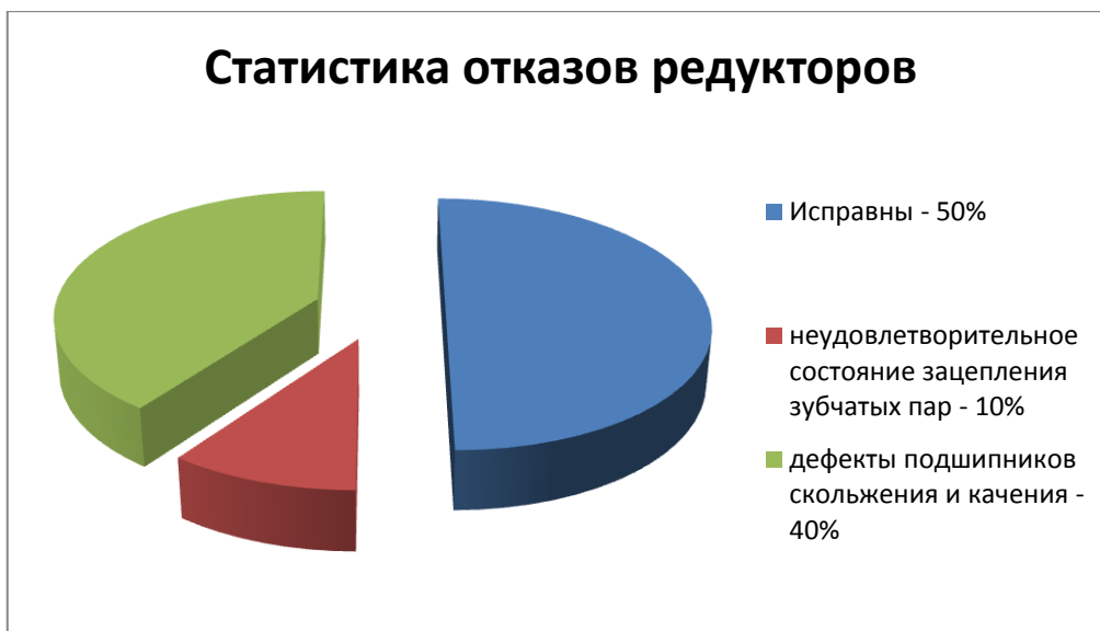
Рисунок 2 – результаты диагностики редукторов
