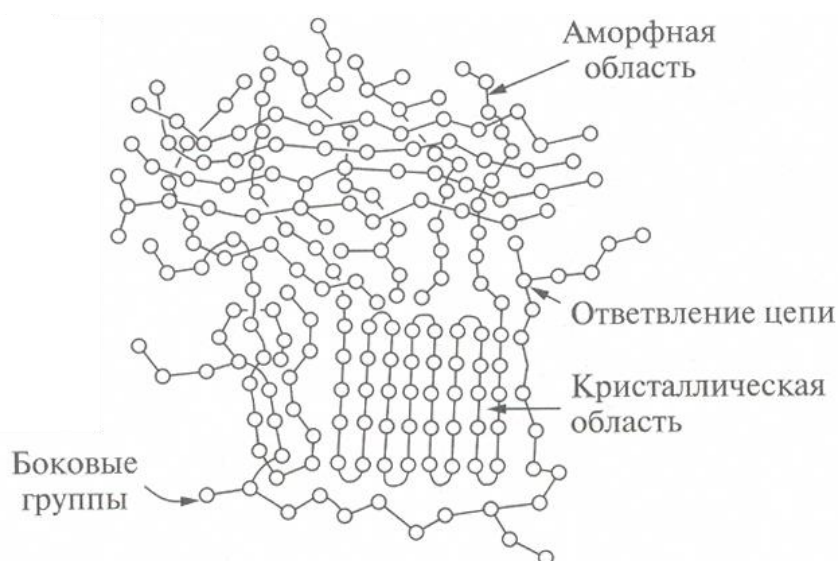
Рис. 8. Полиэтилен низкой плотности. Изображены как аморфные, так и кристаллические области.
