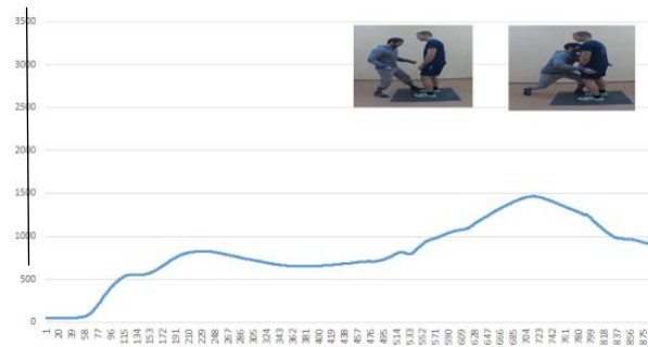
Рис. 4 - Вертикальная составляющая силы реакции опоры в подготовительной фазе
