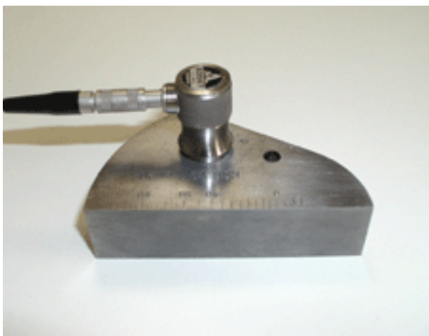
Рисунок 3.5 – Подсоединение преобразователя образцу с плоскопараллельными поверхностями V2M
