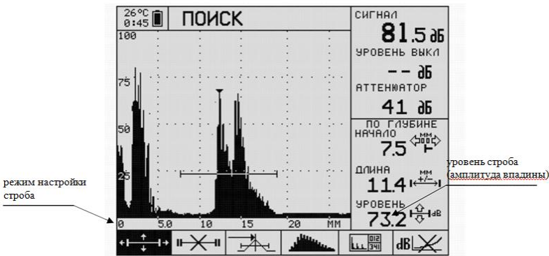
Рисунок 3.16 - Двойной импульс на экране дефектоскопа
