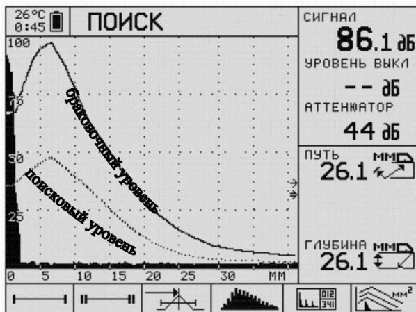
Рисунок 3.8 – Экран дефектоскопа при настройке чувствительности по образцам
