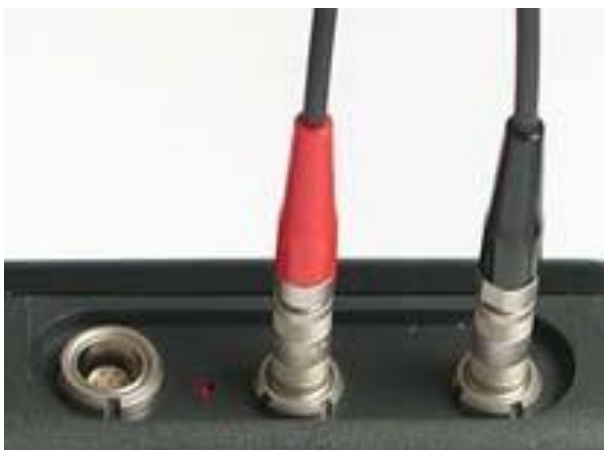
Рисунок 4.1 - Подключение излучающего пьезоэлемента через кабель с красным пояском к разъему, отмеченному красной точкой
