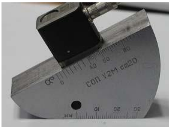
Рисунок 5.25 – Сканирование ПЭП по большей грани V2М, если угол ввода \alpha \leq 62^\circ
