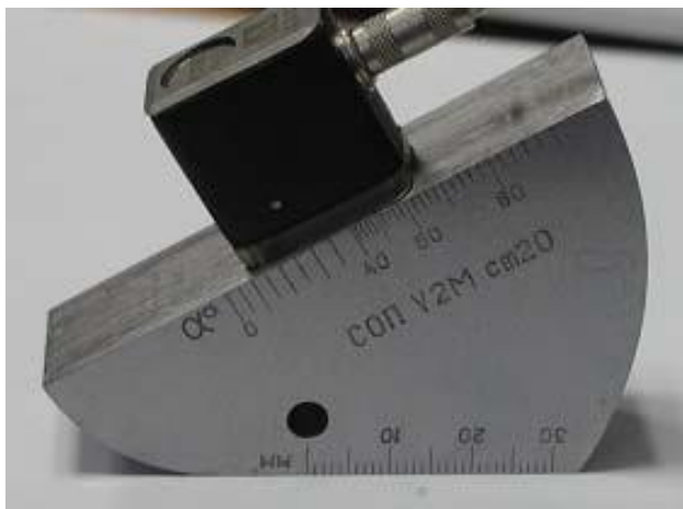
Рисунок 5.9 - Сканирование по большой контактной поверхности образца
