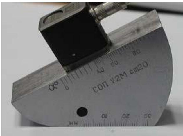
Рисунок 5.13 – Установка дефектометра, если угол ввода \alpha \leq 62^\circ
