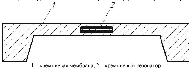
Рис. 2 – Конструкция резонансного преобразователя давления
