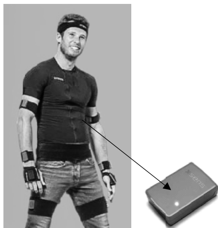
Рис. 1. Костюм, эластичные ремни и сенсор (размеры 47×30×13 мм, вес 16 г) Fig. 1. Xsens motion capture suit, elastic bands, and a sensor (dimensions: 47×30×13 mm, 16 g)
