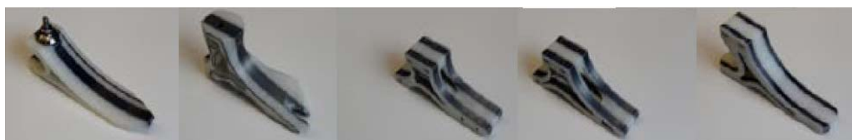
Рис. 10. Пример применения метода трехмерной печати протезов голени с армированием углеволокном Fig. 10. Examples of 3D-printed carbon fiber-reinforced prostheses
