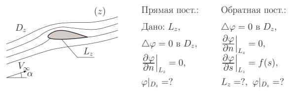
Таким образом, в этой задаче одно из граничных условий, именно  $\frac{\partial \varphi}{\partial n}\Big|_{L_z}=0$ , вытекает из физической сущности задачи (оно отражает непроницаемость профиля). Второе же условие  $\frac{\partial \varphi}{\partial s}\Big|_{L_z}=f(s)$  остается произвольным (разумеется, с известными ограничениями, связанными в конечном счете с существом задачи). Оно является средством для придания тех свойств, которыми должны обладать искомая область и функция в ней.
