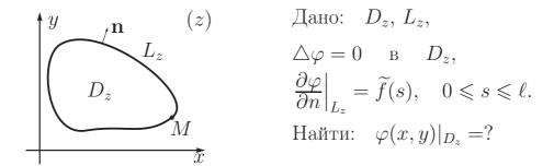
Задача Шварца ставится для аналитической функции: Haй-mи аналитическую в области  $D_z$  и непрерывную вплоть до грани-uы  $L_z$  функцию  $w(z) = \varphi(x,y) + i\psi(x,y)$  по известным значениям действительной или мнимой части этой функции на  $L_z$ . Математическая формулировка:
