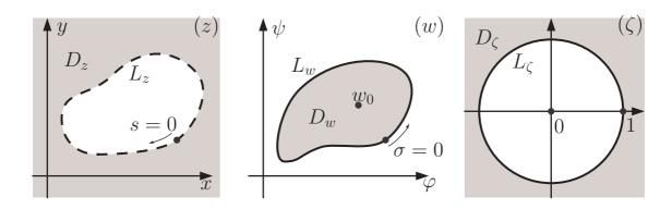
Постановка задачи и схема решения. Дадим постановку задачи Нужина: найти область  $D_z$  по заданным на  $L_z$  значениям регулярной функции  $w(z)=\varphi(x,y)+i\psi(x,y)$ :  $\varphi=f_1(s),\,\psi=f_2(s)$
