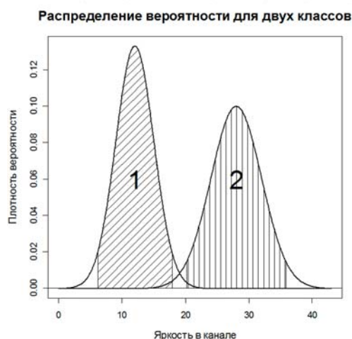
Рис. 3. Пример решающего правила при использовании одного канала
