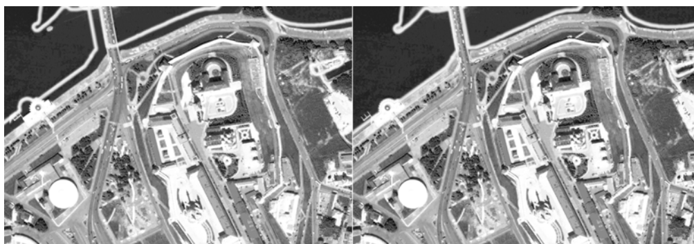
Рис. 1. Фрагменты изображений до и после процедуры уточнения географической привязки
