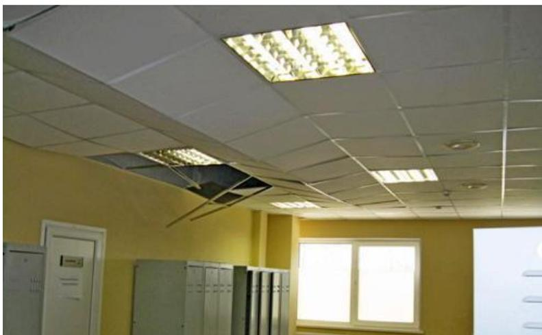
Рисунок 3 – Проверка на надежность крепления подшивных или подвесных потолков и других конструкций от выдавливания при изменении давления внутри помещений во время испытаний
