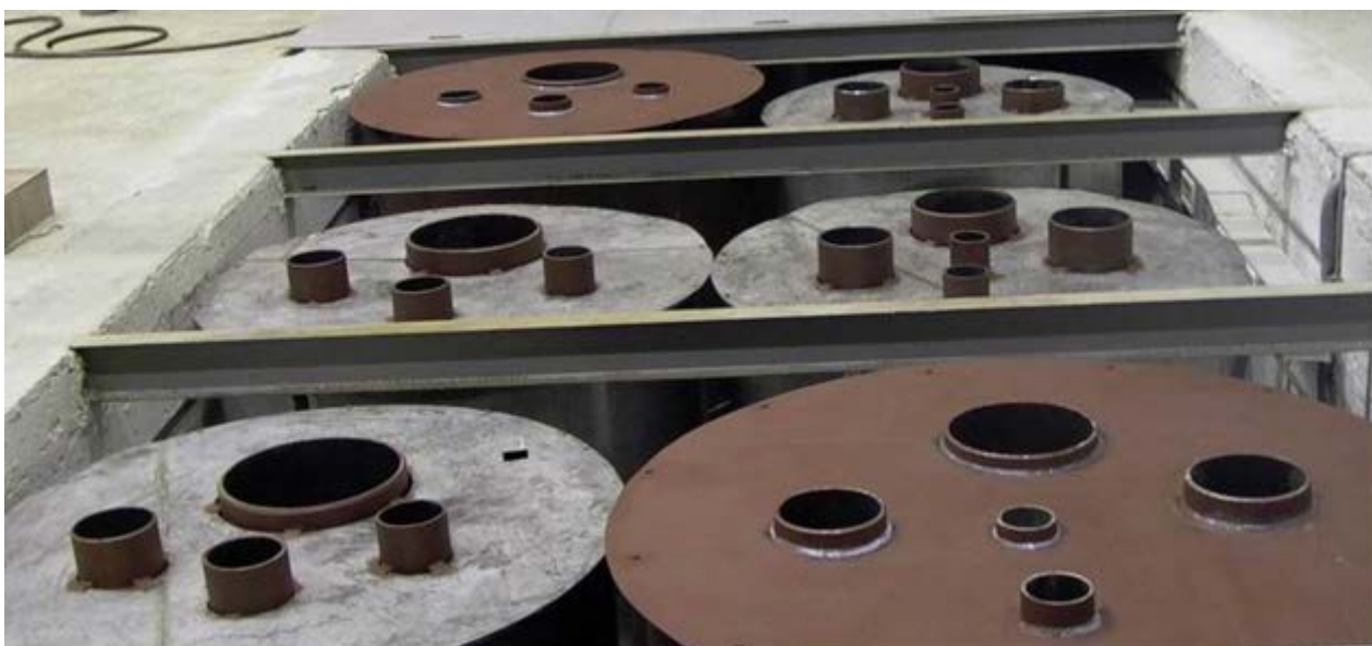
Рис. 19. Фото комплекта СО плотности вещества в затрубном пространстве колонн диаметром 114, 146, 168, 178, 219, 245, 324, 430 мм
