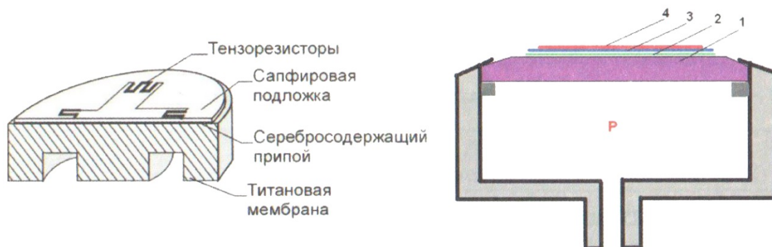
Рис. 31. Упрощенный вид тензорезистивного чувствительного элемента. 1 – мембрана; 2 – клей; 3– сапфировая пластина; 4 – тензорезистор
