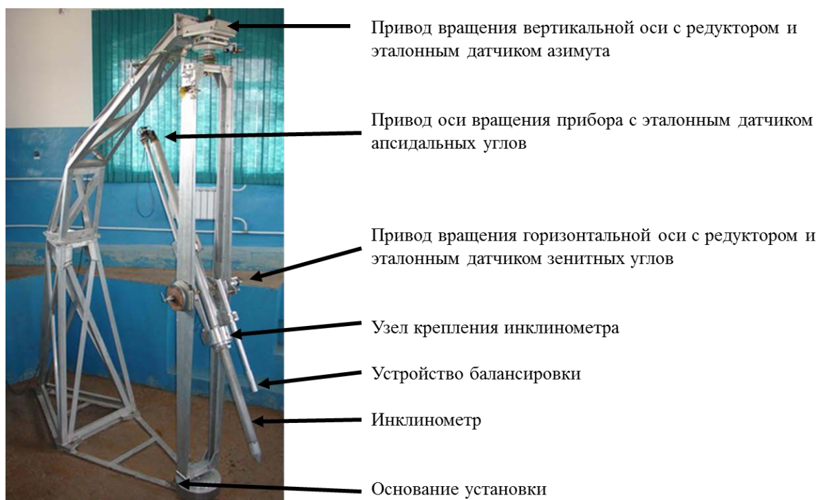
Рис. 15. Общий вид установки УАК-СИ-АЗВ для калибровки инклинометров
