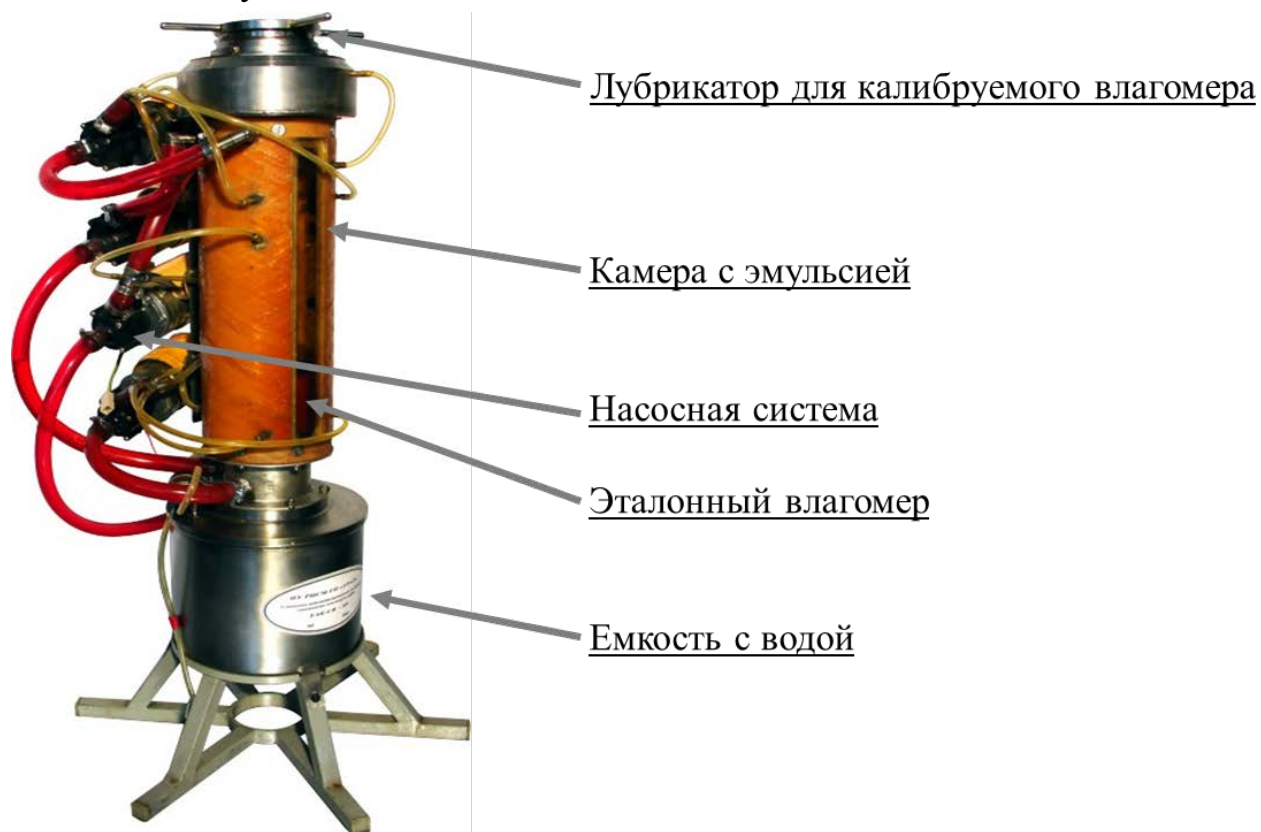
Рис. 12. Общий вид установки УАК-СВ-60 для калибровки скважинных влагомеров
