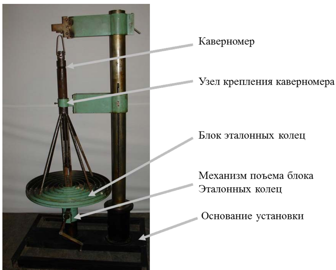
Рис. 8. Общий вид установки УПК-1 для калибровки и поверки каверномеров и профилемеров
