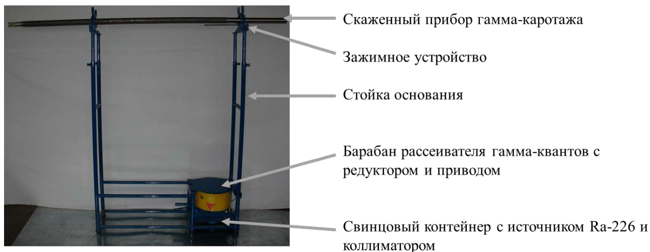
Рис. 5. Общий вид установки УАК-ГК-50 для автоматизированной калибровки аппаратуры ИГК
