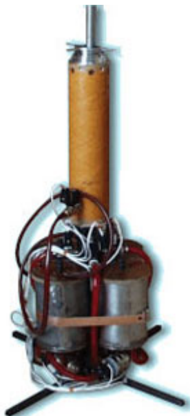
Рис. 14 Общий вид установки УАК-СИР для калибровки скважинных резистивиметров
