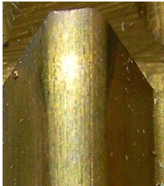
Рис.2 Фрагмент зуба червячной фрезы с дефектом передней кромки
