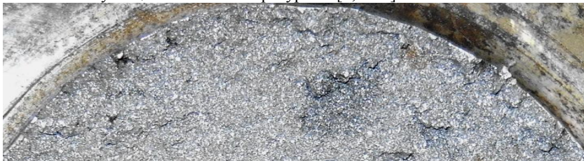
Рис.1 Фрагмент излома тяги
