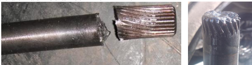
Рис.1. Полуоси автомобиля «КАМАЗ» с наиболее распространёнными местами разрушения
