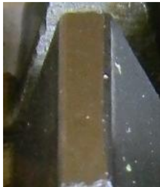
Рис. 3 Фрагмент зуба червячной фрезы с наплавкой порошка Ni-Cr-B-Si-Fe, BoroTec - Eutalloy® 10009 -
