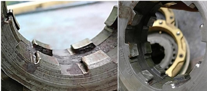
Рис. 1. Износ внутренних шлицев каретки синхронизатора IV-V передач КПП КАМАЗ
