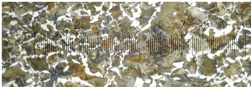
Рис.3 Микроструктура металла тяги при (60 x )
