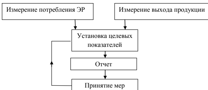
Рис. 1. Схема функционирования системы ЦЭМ на промышленном предприятии [2] ЭР – энергетический ресурс
