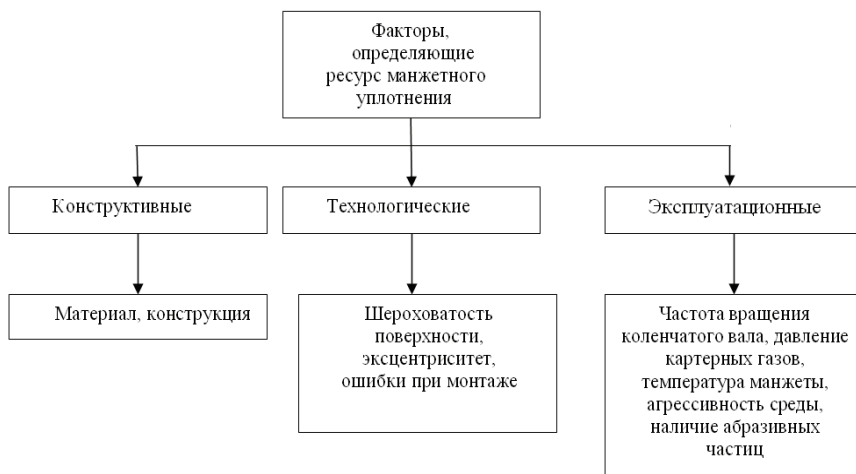
Рис. 1. Факторы, определяющие ресурс манжетного уплотнения
