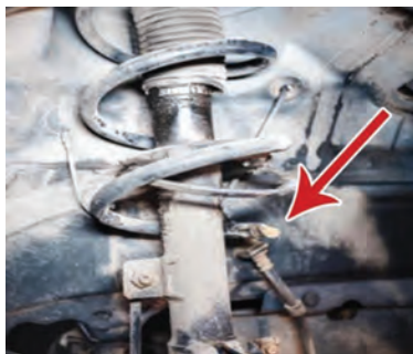
Рис. 2. Лопнувшая пружина подвески легкового автомобиля
