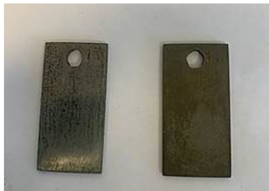
Рисунок 3. Образцы стали 3 после гравиметрического испытания в течение 24 часов в среде с барботируемым хлороводородом
