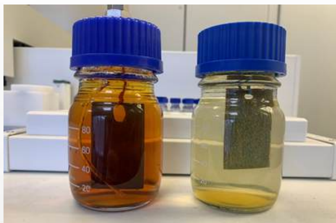
Рисунок 2. Стальные образцы (Ст. 3) после 24 ч погружения в испытуемую среду
