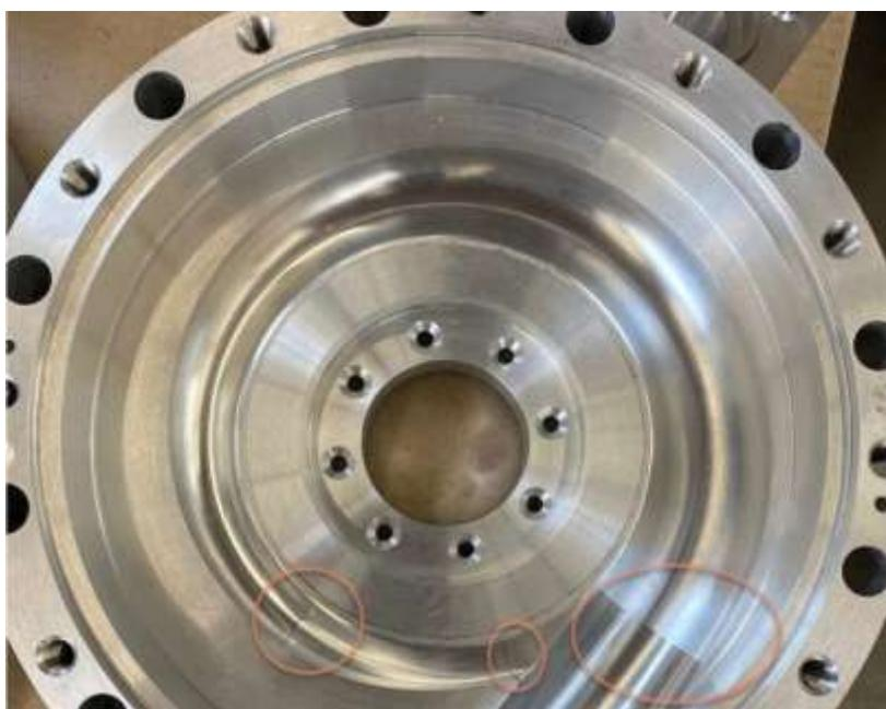
***Рисунок 2. Выявление причин возникновения неровностей на внутренней спиральной поверхности корпуса турбины***
