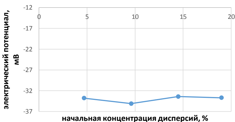
Рис. 6.7. Зависимость электрокинетического потенциала частиц глинистых дисперсий, сформированных на катодите ЭХА воды, от их начальной концентрации
