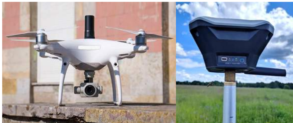
Рис. 1. Квадрокоптер DJI Phantom 4 (а), GNSS приемник Emlid Reach RS+ (б)
