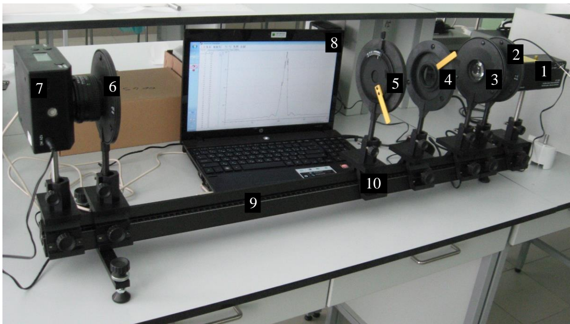
Рис. 2 Внешний вид установки для наблюдения дифракции на щели с помощью системы VideoCom.
