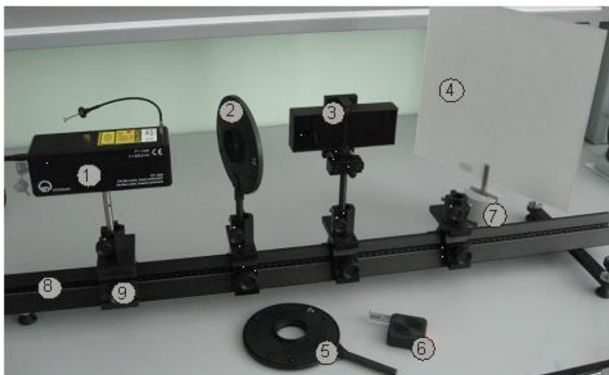
Рис.1. Общий вид установки для наблюдения интерференции с помощью схемы «Зеркало Ллойда»
