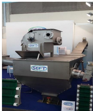
Рисунок 2. Мини комбинированная установка GDE/D (барабанная решетка, песколовка, жируловитель). Производительность 6 л/с. Высота установки 2,2 метра (помещается в контейнер). Компактное решение для механической очистки хозяйственно-бытовых сточных вод малых поселков, удаленных районов крайнего севера, для КОС в контейнерном исполнении.
