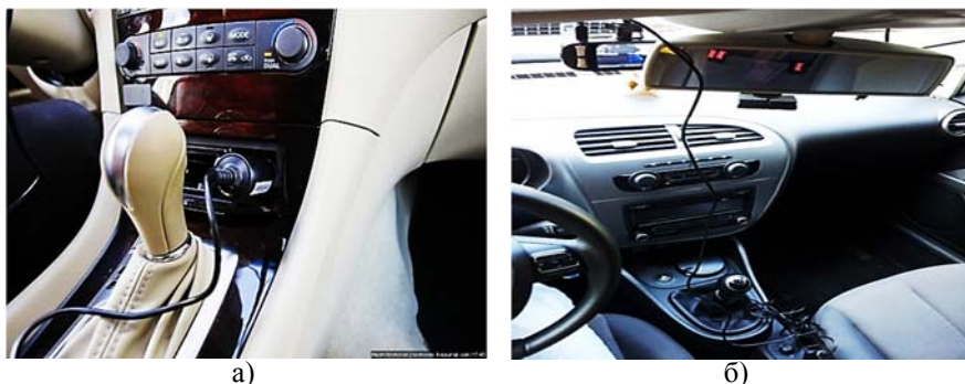
а) б) Рис. 2. Примеры неправильного расположения кабелей
