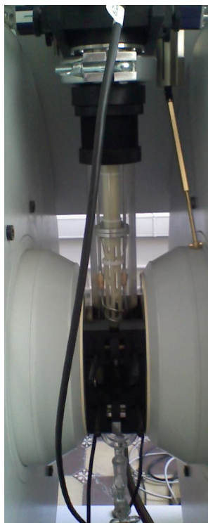
Рисунок 4.4 Диэлектрический резонатор с блоком азотного проточного криостата.
