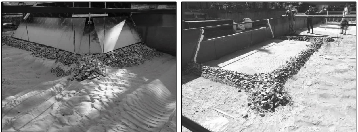
Рис. 1. Исследования размывов дна на крупномасштабной модели.
