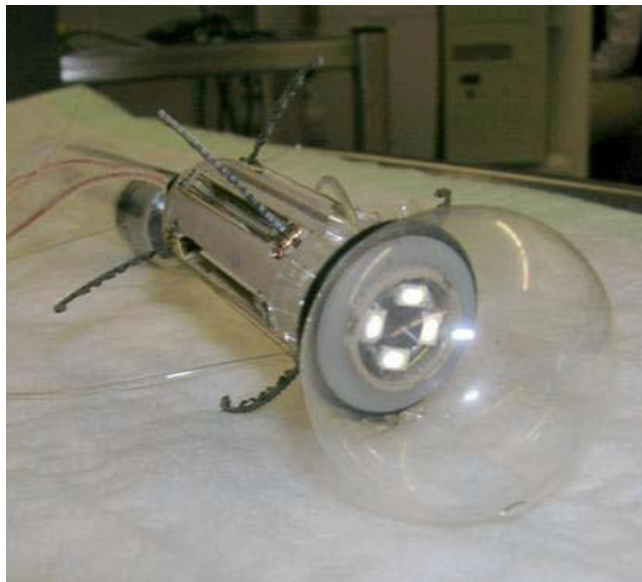
Рис. 62. Фотография прототипа капсулы с шестью ногами [71]
