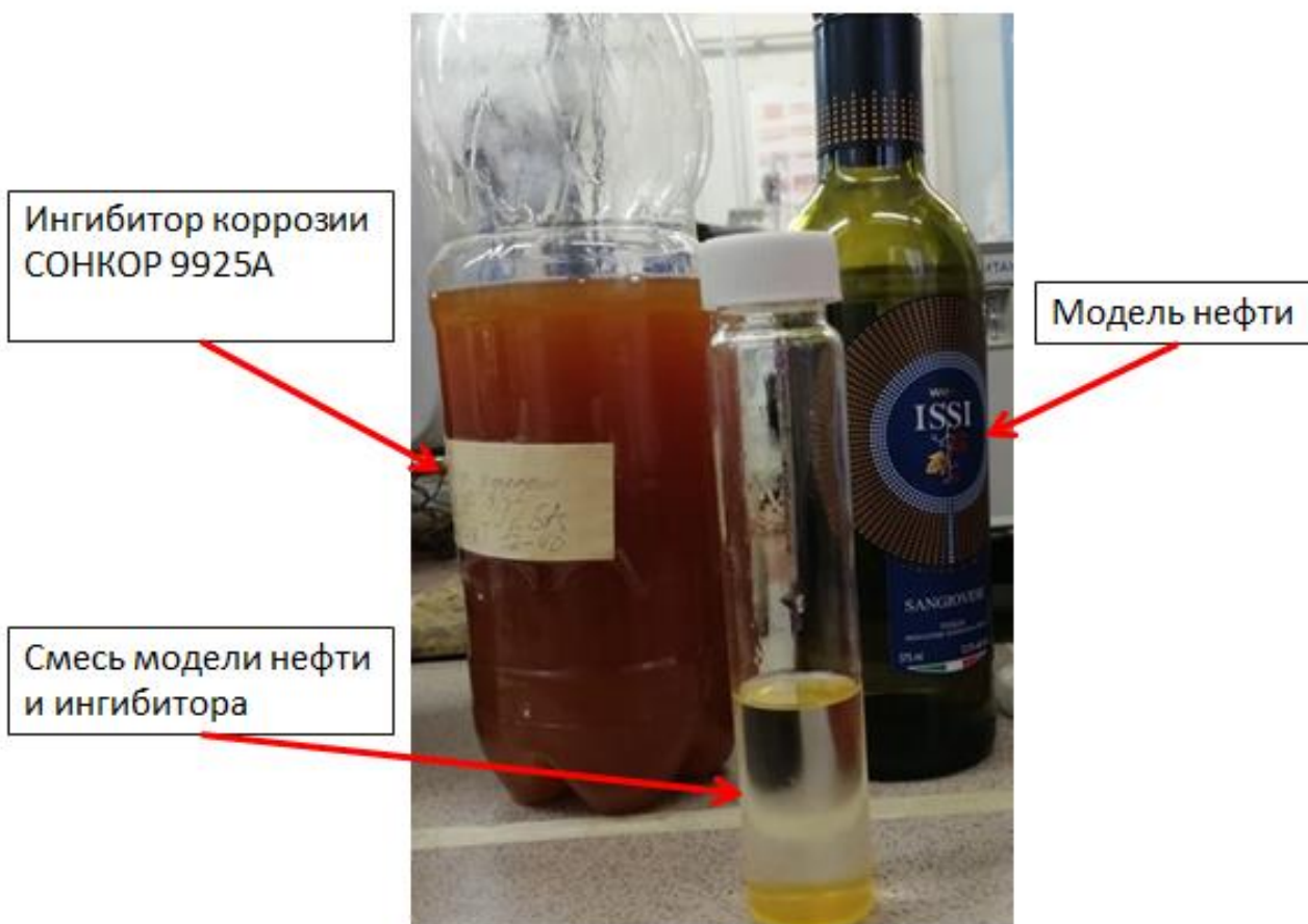
Рис. 2.4. Определение растворимости/диспергируемости ингибитора коррозии в нефти
