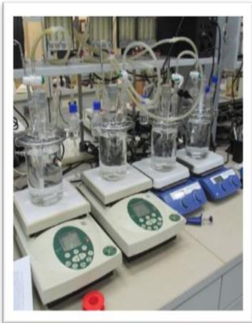
Рис. 1.3. Оборудование для потенциометрического определения эффективности ингибитора коррозии
