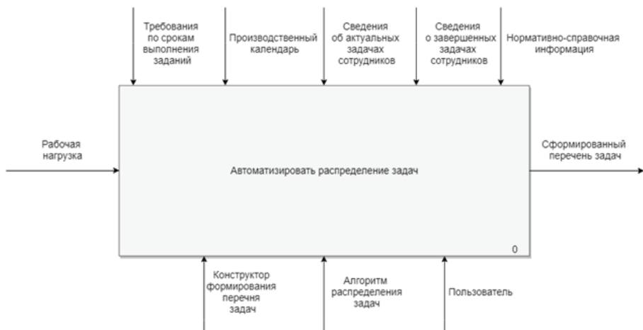
Рисунок 1 – Схема IDEF0 процесса «Автоматизировать распределение задач» (блок А0)
