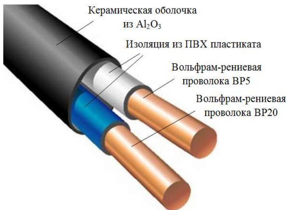
Рис. 3 Схема строения термопары, применяемой в СВС-Аз
