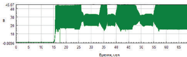
Рисунок 2 - Графики изменения выходного тока генератора, частоты вращения коленчатого вала двигателя, значений напряжений на клеммах «30» при запуске автомобиля акцептора (во время буксировки) без аккумуляторных батарей
