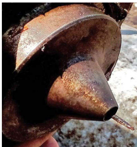
Рис. 3 — Сопло с выдвигающейся иглой Fig. 3 — A nozzle with a retractable needle
