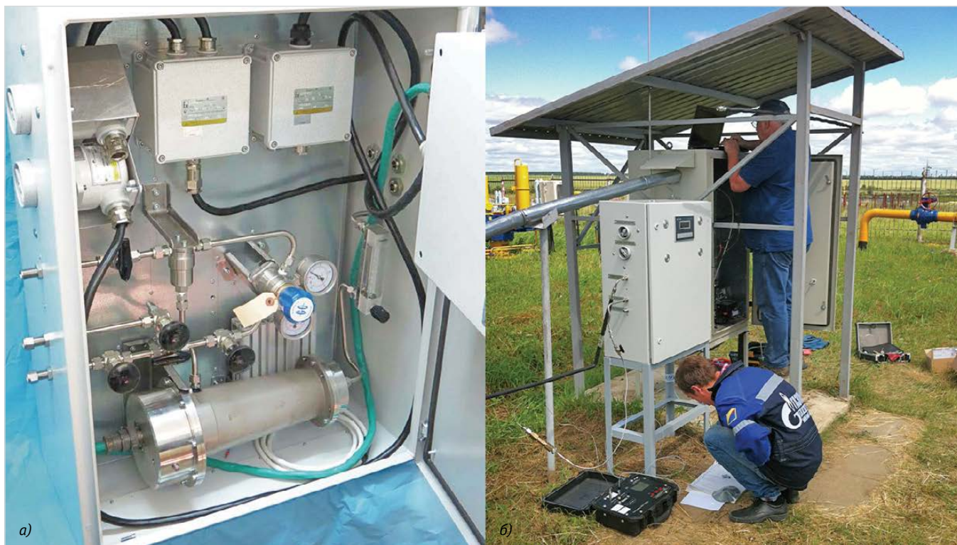
Рис. 4 — Фото гигрометра «ГЛ-02»: а — с открытой передней дверцей; б — на объекте КС Торбеевская
