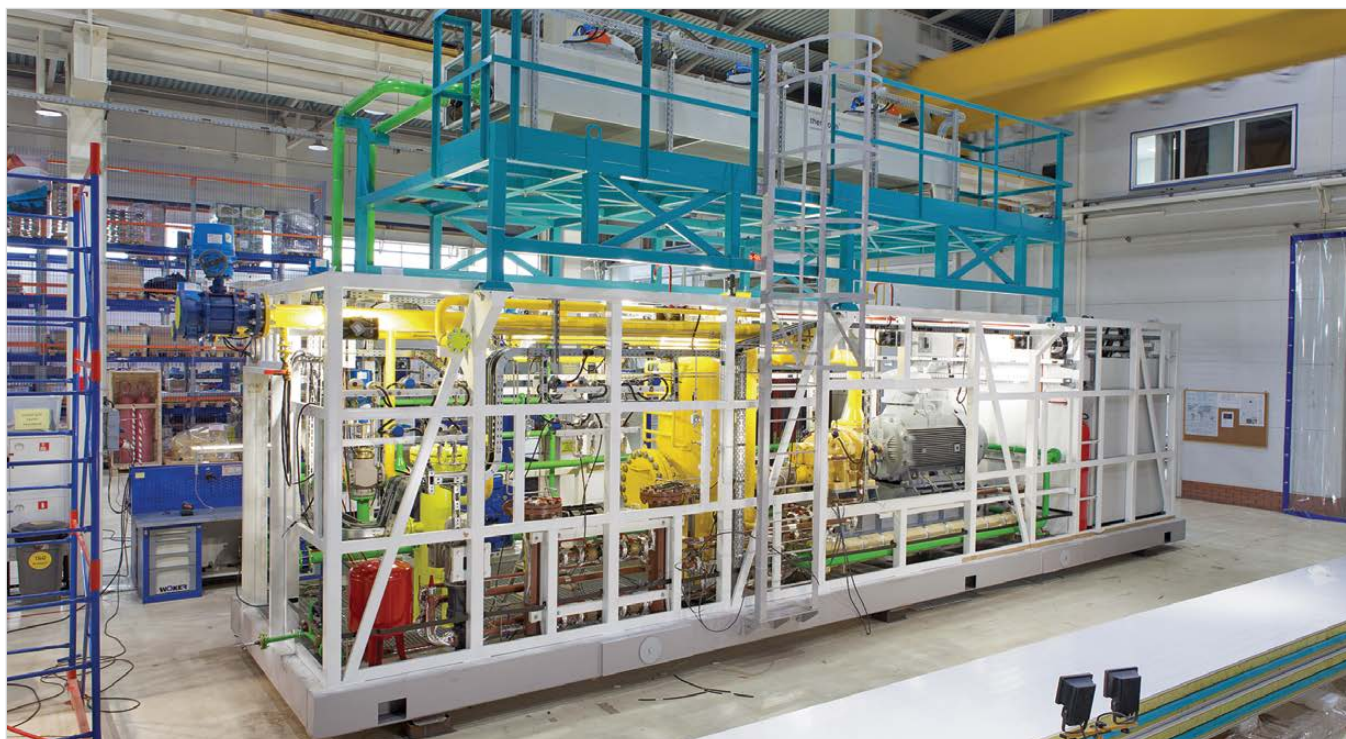
Дожимная компрессорная станция GEA для компримирования топливного газа, завод GEA, г. Климовск, Московская обл.
