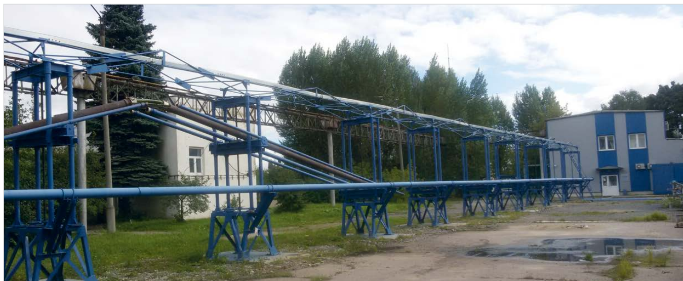
Рис. 3 — Стенд для исследований газожидкостных потоков в шлейфах сложной конфигурации
