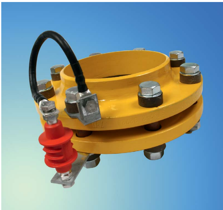
Рис. 4 — Пример шунтирования изолирующего фланцевого соединения с помощью разделительного искрового разрядника EXFS 100
