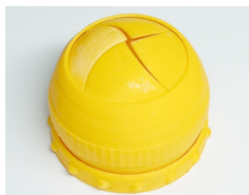
Рис. 1 – Коробочка с лепестковым запорным механизмом – демонстрация возможности печати механизмов повышенной прочности, не требующих сборки
