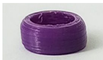
Рис.3 – Смещение слоев влево из-за некачественной калибровки принтера (ослабленные ремни)
