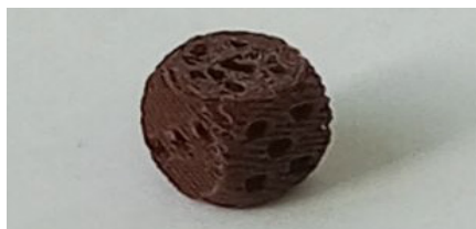
Рис.4 – Недоэкструзия пластика из-за завышения диаметра прутка в слайсере
