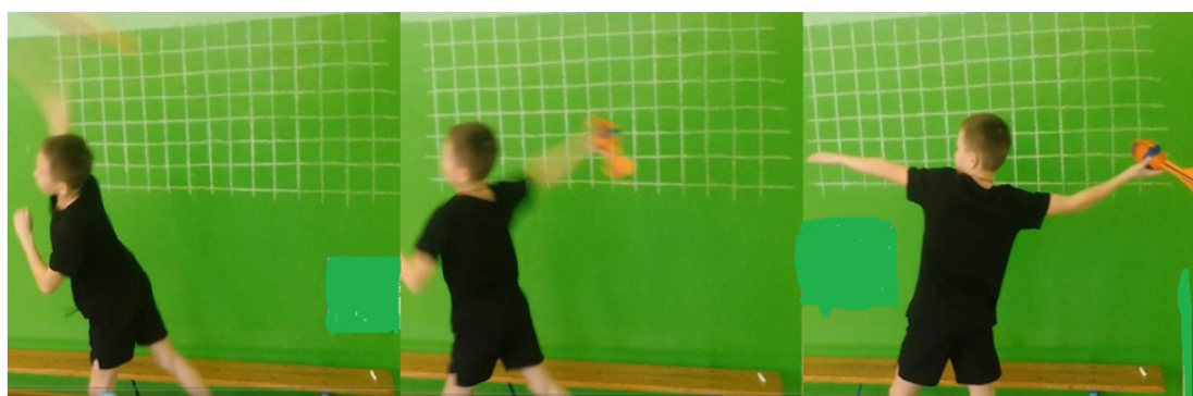
Рис. 1 – Использование видеосъёмки метания снаряда на фоне градуированной сетки для определения скорости вылета и виртуальной дальности полёта снаряда
