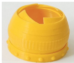
Рис. 5 – Разламывание распечатки вдоль слоев из-за использования хранившегося в ненадлежащих условиях пластика
