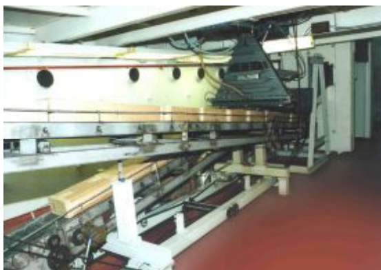
Рис.1 Ускоритель типа ИЛУ производства ИЯФ СО РАН с конвейерной системой.
