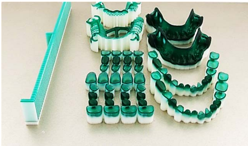
Рис. 2. Формы для отливки зубов, напечатанные 3D-принтером
