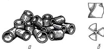
Рис.3. Виды конструкций насадок: а– кольца Рашига; б–пропеллерная насадка[2]
