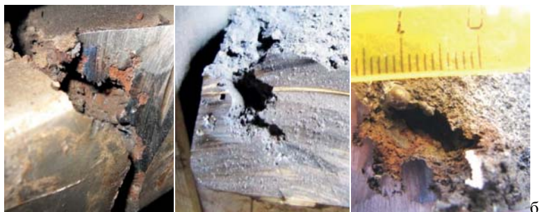
Рис.1 Характер излома корпуса (а) и примеры макродефектов литья (б)
