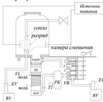
Рисунок 1 - Схема установки для ионно-плазменного азотирования
