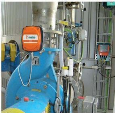
Рисунок 2 - Прибор для контролирования концентрации суспензии
