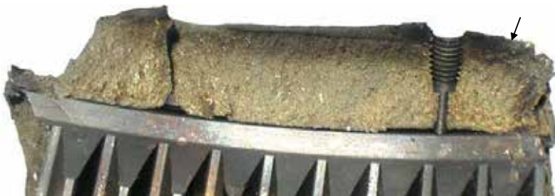
Рис. 4 Фрагмент разрушенного планетарного колеса
