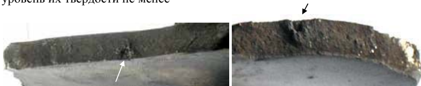
Рис.3 Фрагменты изломов разрушенного корпуса планетарного редуктора
