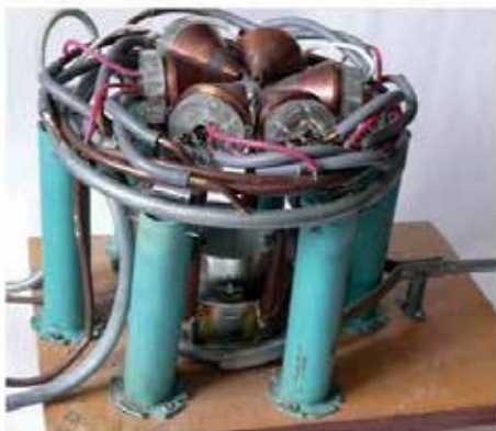
Рис. 2 – Шестиструйный электродуговой плазматрон.
