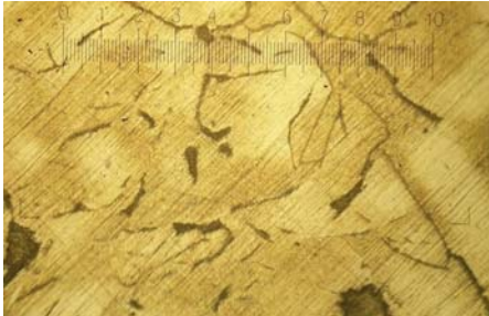
Рис.4 Микроструктура металла крышки лицевой (образец №26 припуск) x420
