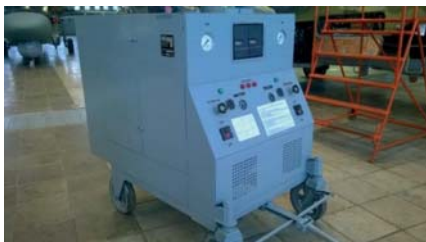
Рисунок 2. Стенд отработки гидросистем вертолета Ка-52 после модернизации
