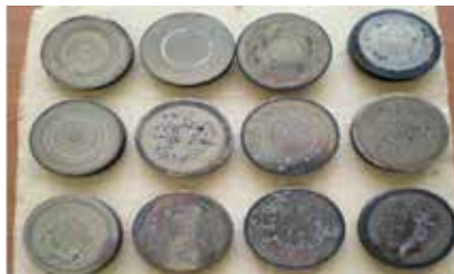
Рис. 2 Вид и характер износа поверхности толкателя клапана.
