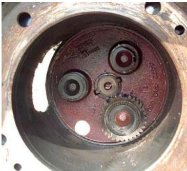
Рис.1 Внутренняя полость корпуса Рис.2 Разрушенное планетарное колесо
