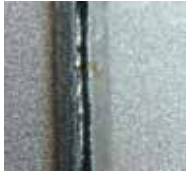
Рис. 1. Фото сварного шва непрерывным ЛИ без стабилизации параметров ЛТК.
