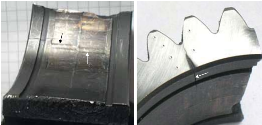
Рис.5 Фрагменты разрушенного сателлита
