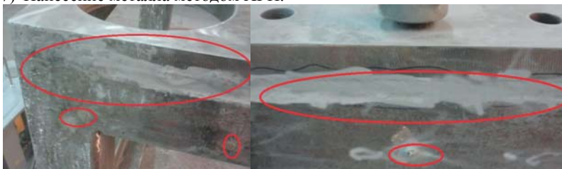
8) Механическая зачистка восстановленных поверхностей.
