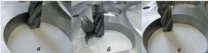
рис. 4 а– трохоидальное фрезерование, реализуемая циклом, соответствующим рис 3а, б - обработка на проход полной шириной фрезы, в - трохоидальное фрезерование по программе от NX-CAM.
