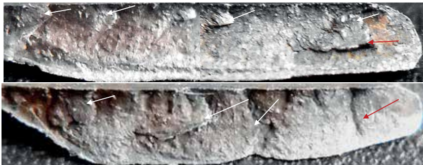
Рис.2 Фрагменты изломов, образцов диска компрессора 7-й ступени
