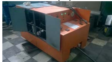
Рисунок 1. Стенд отработки гидросистем вертолетов Ка-52 для проведения модернизации
