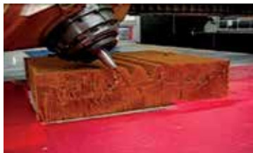
Рисунок 3. Предварительная обработка блока ПСП с использованием режущих пластин. раскладок.
