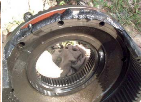
Рис.1 Внутренняя полость корпуса Рис.2 Разрушенное планетарное колесо
