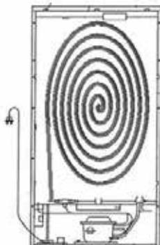
Рис. 2 Внешний вид холодильника с конденсатором из полимерного материала.
