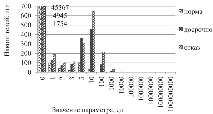
Рисунок 5. Количество накопителей, имеющих значение SMART-параметра 187 Reported uncorrectable errors в определенном диапазоне: нормально работающих (слева в каждой группе), снятых досрочно (посередине), отказавших (справа)
