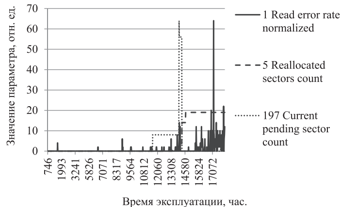
Рисунок 9. Зависимость значений SMART-параметров 1 (сплошная линия), 5 (пунктир) и 197 (точки) от времени эксплуатации накопителя информации с серийным номером Z262EBNAS модели Toshiba DT01ACA300
