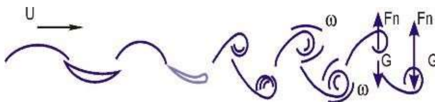
Рисунок 4. Схема образования вихрей на волновой поверхности раздела фаз «нефть–вода».
