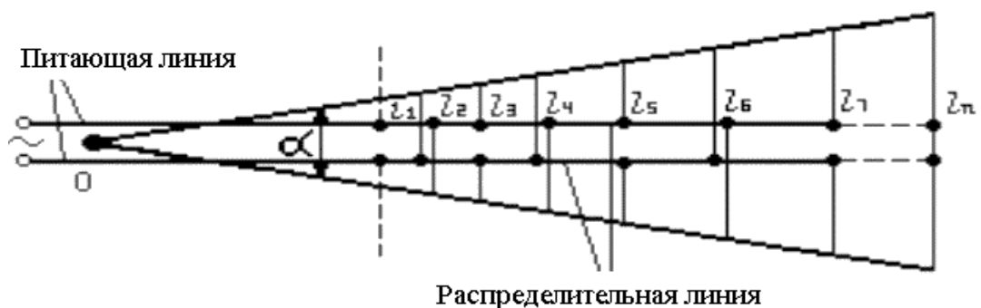
Рис. 1.14. Конструкция логопериодической антенны
