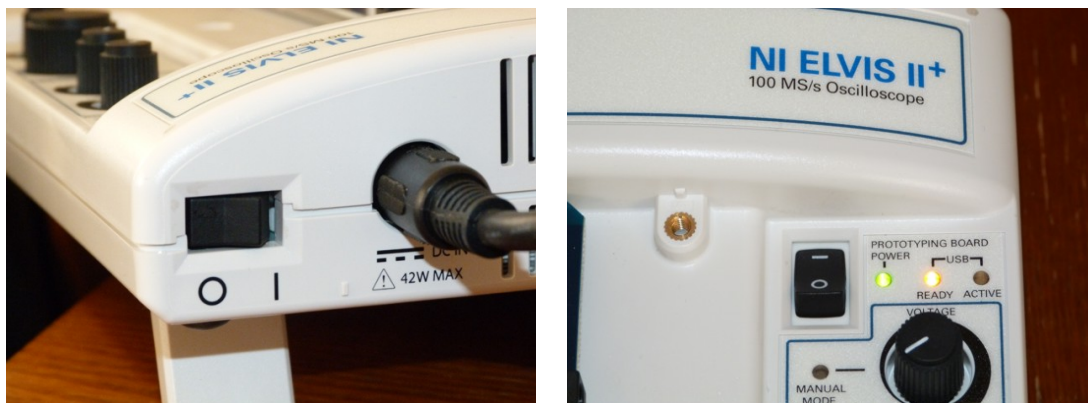
Рис. 1.3. Включение питания на платформе NI ELVIS II +
